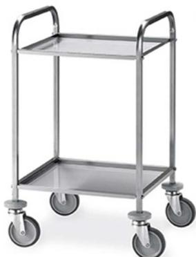
Struttura in tubo di acciaio inox AISI 304, sezione cm 2x2, finitura spazzolata. Piani asportabili manualmente in acciaio inox a forma di vasca con bordo a 90° anti taglio, profondità cm 1,5 h. Paracolpi in gomma grigia agli angoli. Ruote piroettanti Ø cm 12,5 con ruota in gomma grigia e supporto in ferro zincato. Carrello imballato smontato.
