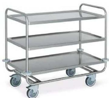
Realizzati completamente in acciaio inox AISI 304, finitura spazzolata. Struttura portante costituita da telaio chiuso in tubo tondo di acciaio inox Ø cm 2,5. Piani stampati a forma di vassoio con superfici arrotondate, insonorizzati, saldati al telaio. Paracolpi in gomma grigia. Ruote piroettanti Ø cm 12,5, di cui due con freno, con ruota in gomma grigia e supporto in ferro zincato. Carrello imballato smontato.
