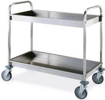
Struttura in tubo di acciaio inox AISI 304, sezione cm 2x2, finitura spazzolata. Piani asportabili in acciaio inox a forma di vasca con bordo a 90° antitaglio, profondità cm 6,5 h. Paracolpi in gomma grigia agli angoli. Ruote piroettanti Ø cm 12,5, con ruota in gomma grigia e supporto in ferro zincato. Carrello imballato smontato
