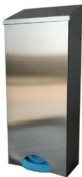
*Dispenser a muro per monouso sfuso, realizzato completamente in acciaio inox aisi 304 / scotch brite spessore mm 0,8. Parti assemblate con rivetti. Chiusura con sportello nella parte superiore. Tetto inclinato per evitare l'accumulo di polvere e l'appoggio di oggetti che potrebbero compromettere la sicurezza.*
