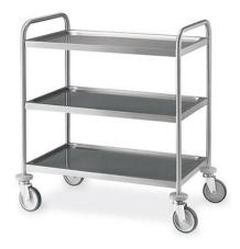
Carrelli con ripiani stampati, saldati al telaio realizzato con tubo 25x25. Materiale acciaio inox AISI 304 con finitura satinata.
