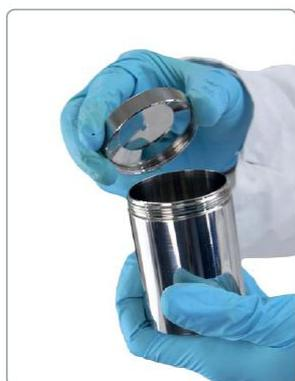
**Materiale acciaio inox AISI 316** finitura lucida con tappo a vite non a tenuta
