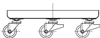
Carrello per contenitori in acciaio inox, con n°4 ruote in gomma girevoli, una ruota con freno
